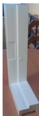
Houten kozijn (schaalmodel) voorzien van afdekdoopjes
